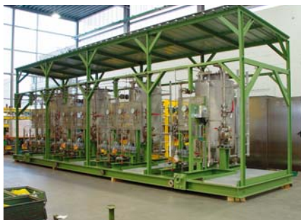
Установка для химического впрыскивания для эксплуатации на суше, Россия
